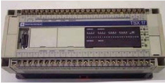
L'API TSX17 possède 26 entrées et 18 sorties
